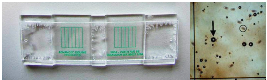
Figur 1. A) Typisk McMaster-slide med to tællekamre. B) Stil skarpt på luftbobler (pil) og floterede strongylideæg (cirkel) vil findes i samme niveau.
