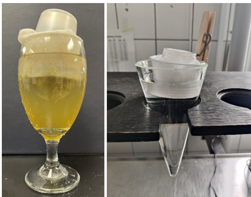
Figur 3. Prøven placeret øverst i et Baermann-glas. På billederne ses to forskellige opstillinger, der kan anvendes. Det er lettest at opsamle larverne, hvis glasset er spidsbundet.
